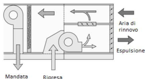
Il modulo VRC permette di gestire percentuali diverse di aria di rinnovo. La camera di miscela a 3 serrande permette di gestire il freecooling, termico, entalpico, che termo-entalpico.
