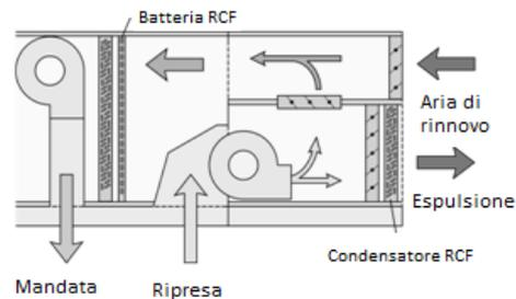
Questo modello con recupero termodinamico include un circuito appositamente dedicato che opera ad elevate prestazioni. Questo circuito utilizza l'aria di ripresa per recuperare parte del calore di espulsione. Attraverso questo recupero è possibile incrementare sia le prestazioni nominali, sia quelle prestazionali dell'unità.
