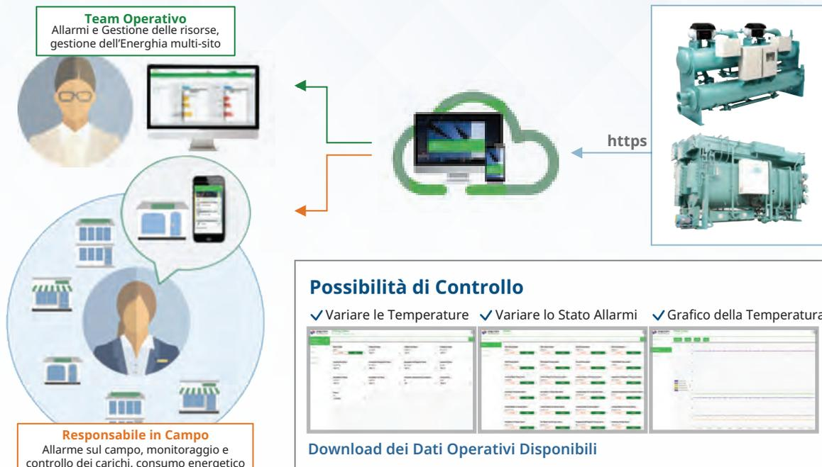
1. E' possibile controllare i dati in tempo reale e quelli trascorsi di: temperature, allarmi, e funzionamento di vari siti di lavoro con controllo a distanza de vari valori impostati.
